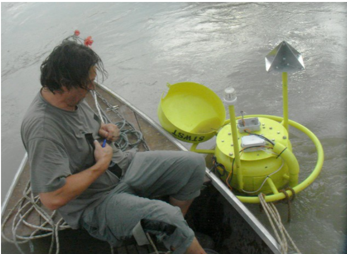
Installation des Unterwassermikrofons
